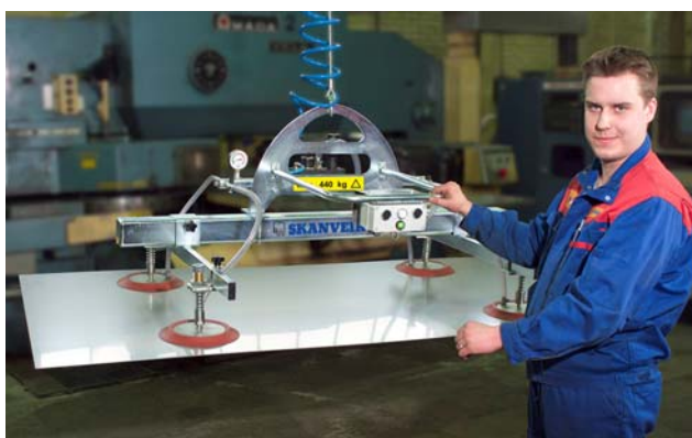
Dumbo vakuumlyftok tillsammans med pelarlyft och Skanveir plåtbyrå är en optimal lösning för plåthantering bl.a. vid laserskärning.
